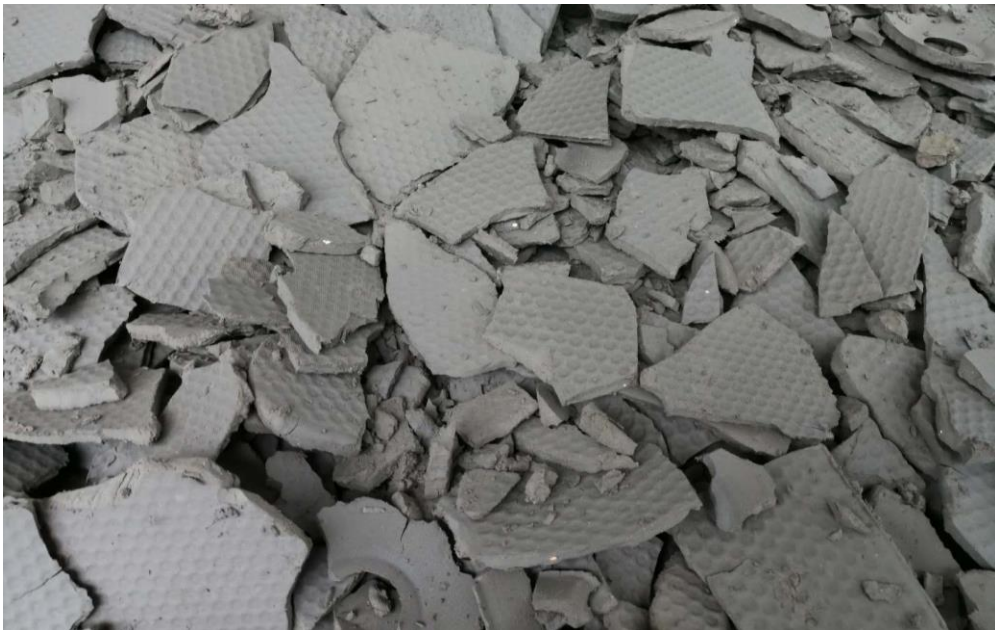
污泥淋滤深度脱水技术实物效果
